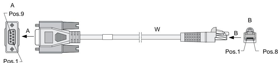
表C-1 配置电缆连接关系
