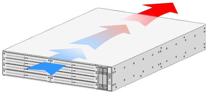
FAN-20B-2-A 为抽风风扇，风向为端口侧进风，电源侧出风，风扇把手为红色。
