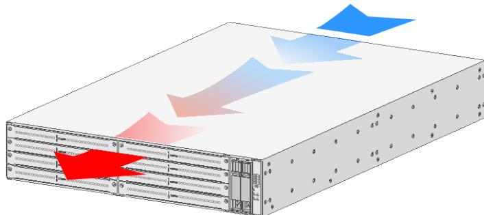
FAN-20F-2-A 为吹风风扇，风向为电源侧进风，端口侧出风，风扇把手为蓝色。
